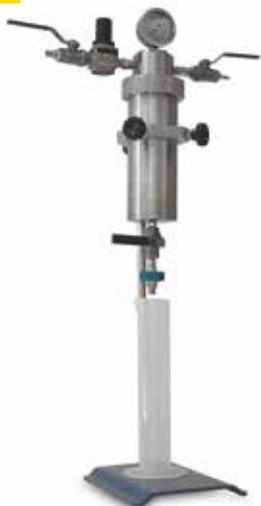
Test filtrabilità inox
