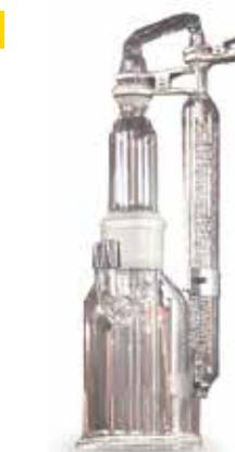
Caldaia, tubo, refrigerante, raccordo
