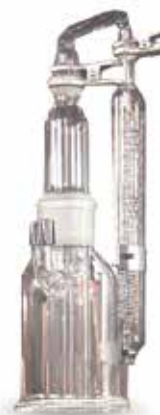
Caldaia, tubo, refrigerante, raccordo
